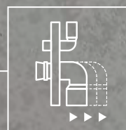
3-stopniowa regulacja głębokości kolana odpływowego 3-ways depth adjustment of the outlet knee
